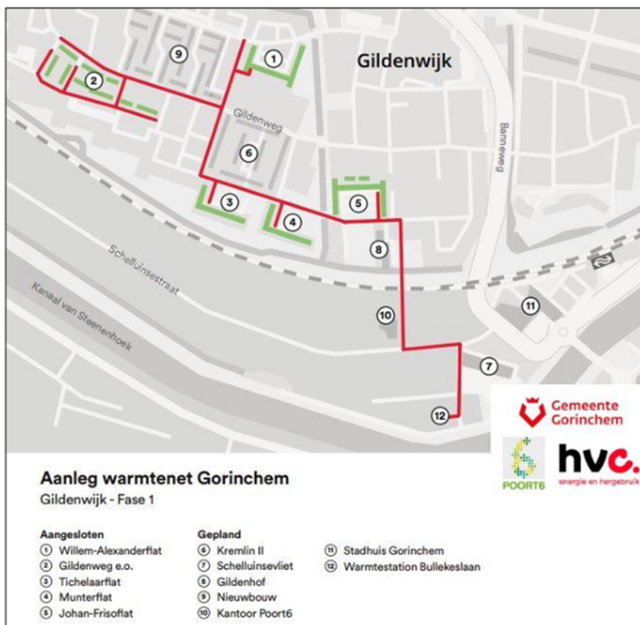
Afbeelding 14: Overzicht van de aangelegde leidingen.
