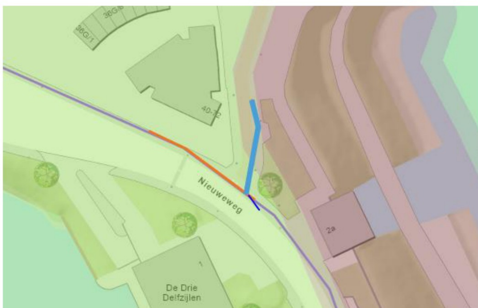
Figuur 1: De oranje lijn toont het tracé van de nieuwe HDPE-leiding. De blauwe lijn geeft het tracé van de bestaande glasvezel weer waarop de GCO wordt geplaatst. De paarse lijnen tonen de globale tracés van de bestaande kabels en leidingen.
