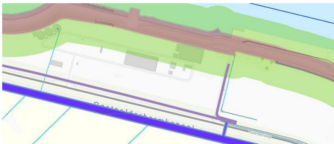
Figuur 1. de paarse belijning toont het globale tracé van de aan te leggen kabels en leidingen. De beperkingengebieden van de primaire waterkering zijn weergegeven, waarbij beperkingengebied III in het groen is aangeduid.
