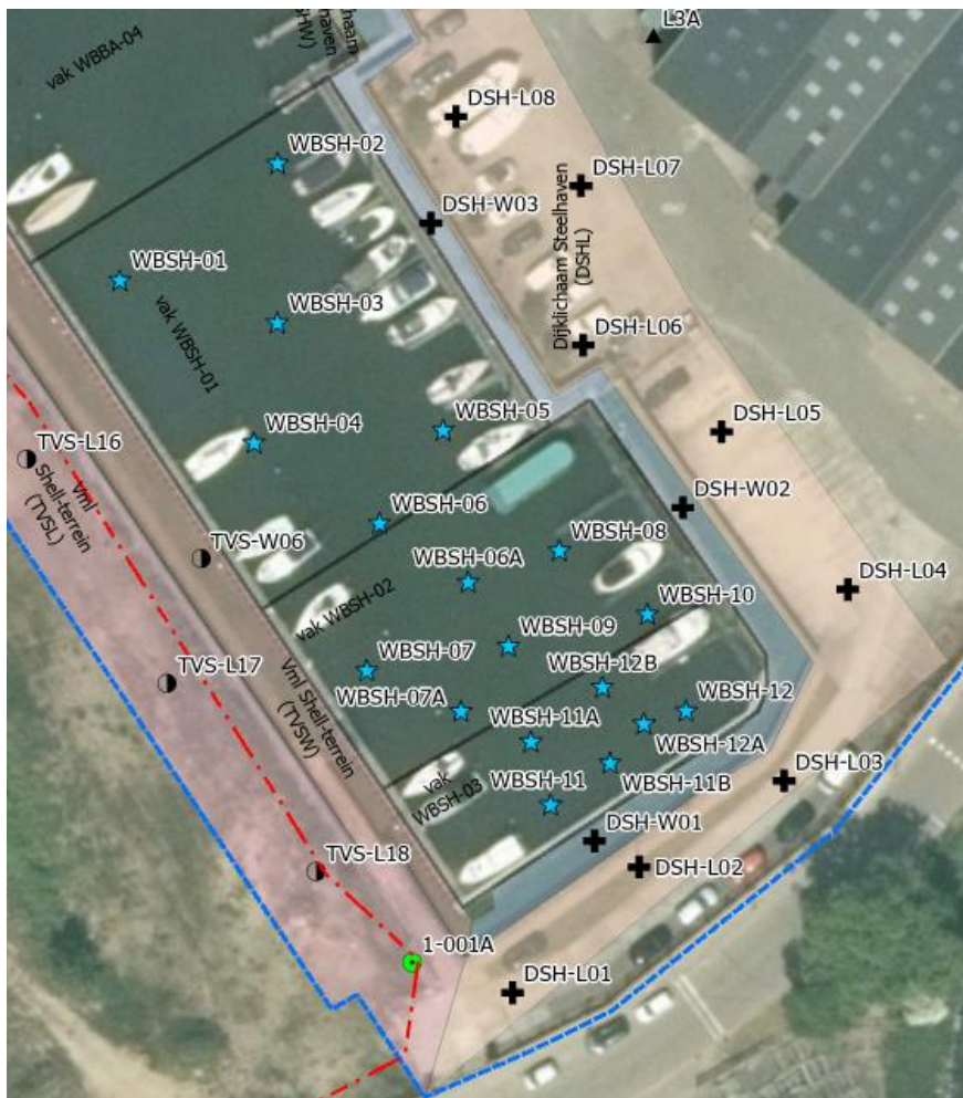
Figuur 17, situering boorpunten DSH-L07 en -L08 ten opzichte van interventiewaardecontour (rode stippellijn) van minerale olie op het Shell-terrein
