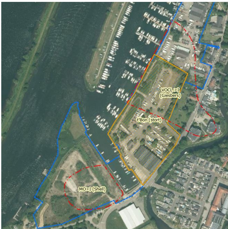
Figuur 12, Contouren Shell (rode contour, grond en grondwater), 't Bon (bruine contour, grond) en Giesbers (rode contour, grondwater) gehalten >Interventiewaarde
