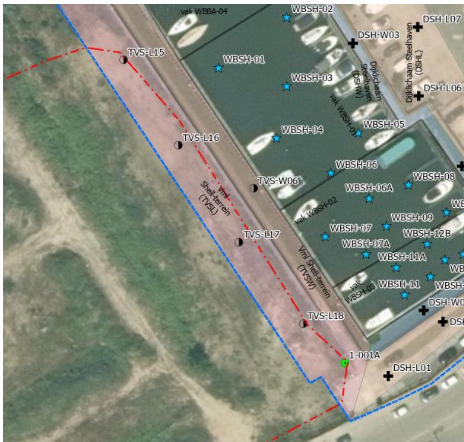
Figuur 15, situering boorpunten (rode contour is de Interventiewaardecontour voor minerale olie op het Shell-terrein)
