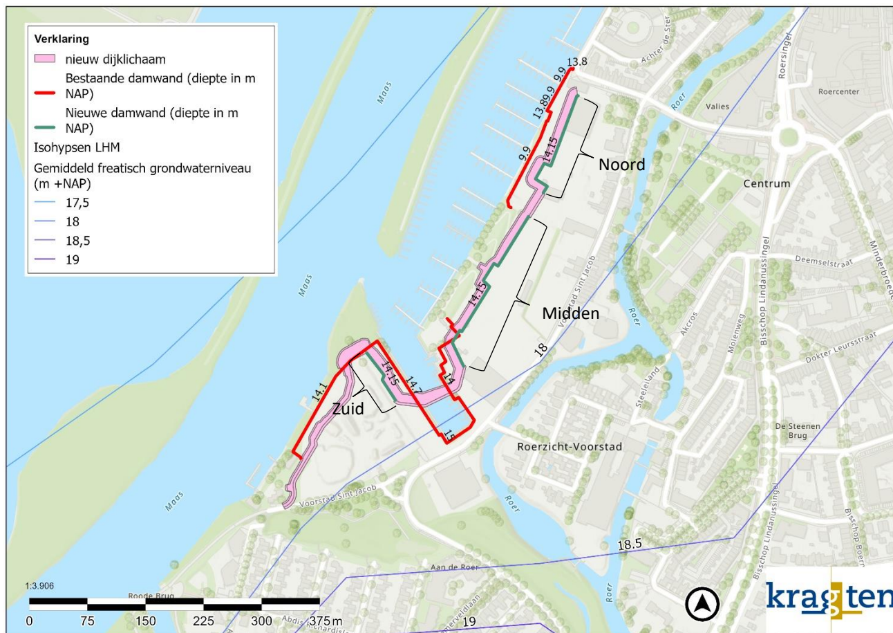
Figuur 14. Bestaande damwand en nieuwe damwand (of verticale constructie; aangeduid met noord, midden en zuid) met daarin de diepte aangegeven. Ook zijn de isohypsen van het gemiddeld freatisch grondwaterniveau weergegeven.
