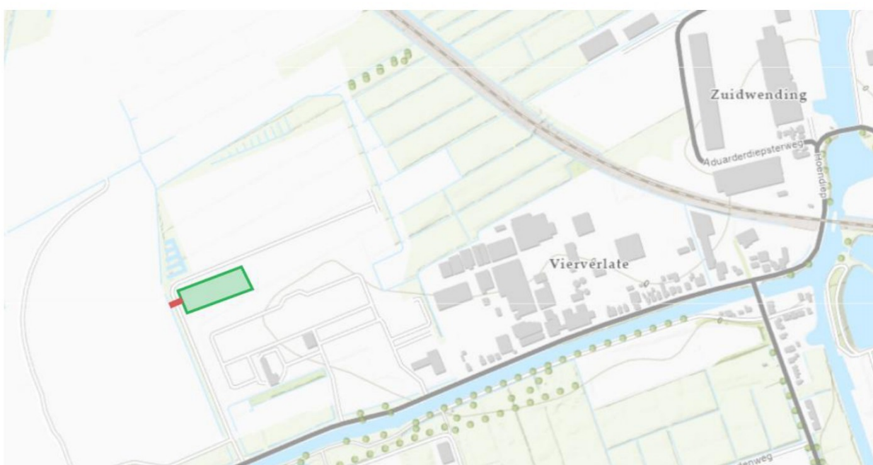
Figuur 1: Locatie van activiteiten. In het groen weergegeven het te graven oppervlaktewater en met de rode lijn weergegeven de locatie van de aan te leggen dam met duiker.
