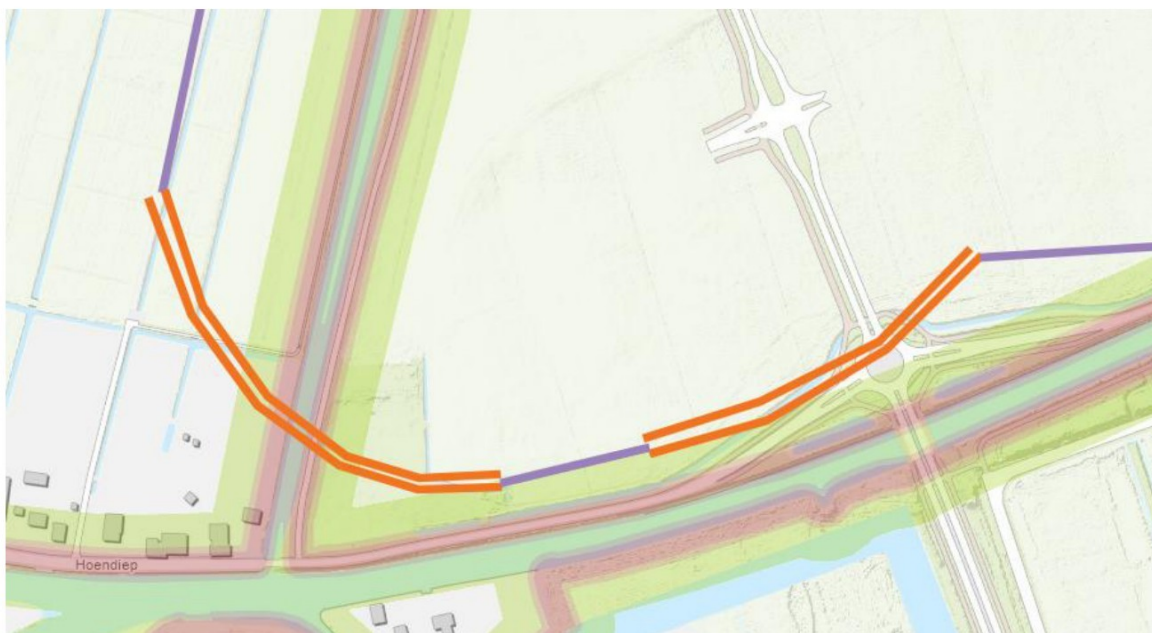
Figuur 1: De oranje belijning geeft globaal het tracé weer van de gestuurde boring. De paarse belijning geeft globaal het tracé weer van de middenspanningskabels. De groene en rode arcering geven de beperkingengebieden weer van de regionale kering.
