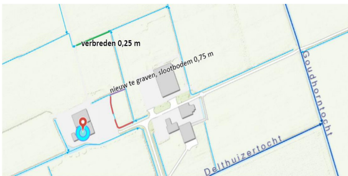
Figuur 1: Locatie van activiteiten. De rode lijn geeft de te dempen watergangen weer. De paarse lijn geeft nieuw te graven watergang weer. De groene lijn geeft te verbreden watergang weer.
