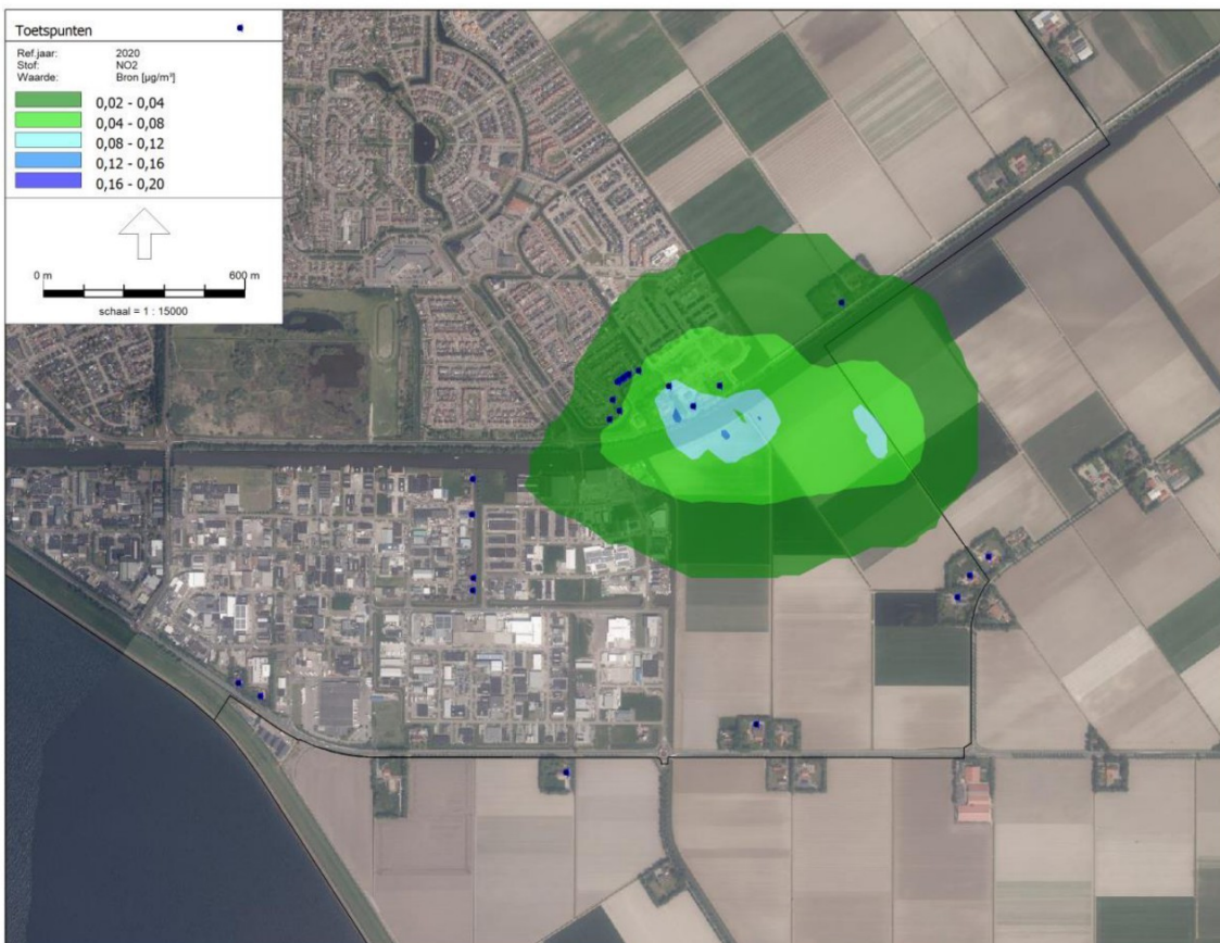
Figuur 9-7: Jaargemiddelde concentratiebijdrage NO 2 in aanlegfase bij ontgrondingswerkzaamheden aan de noordzijde
