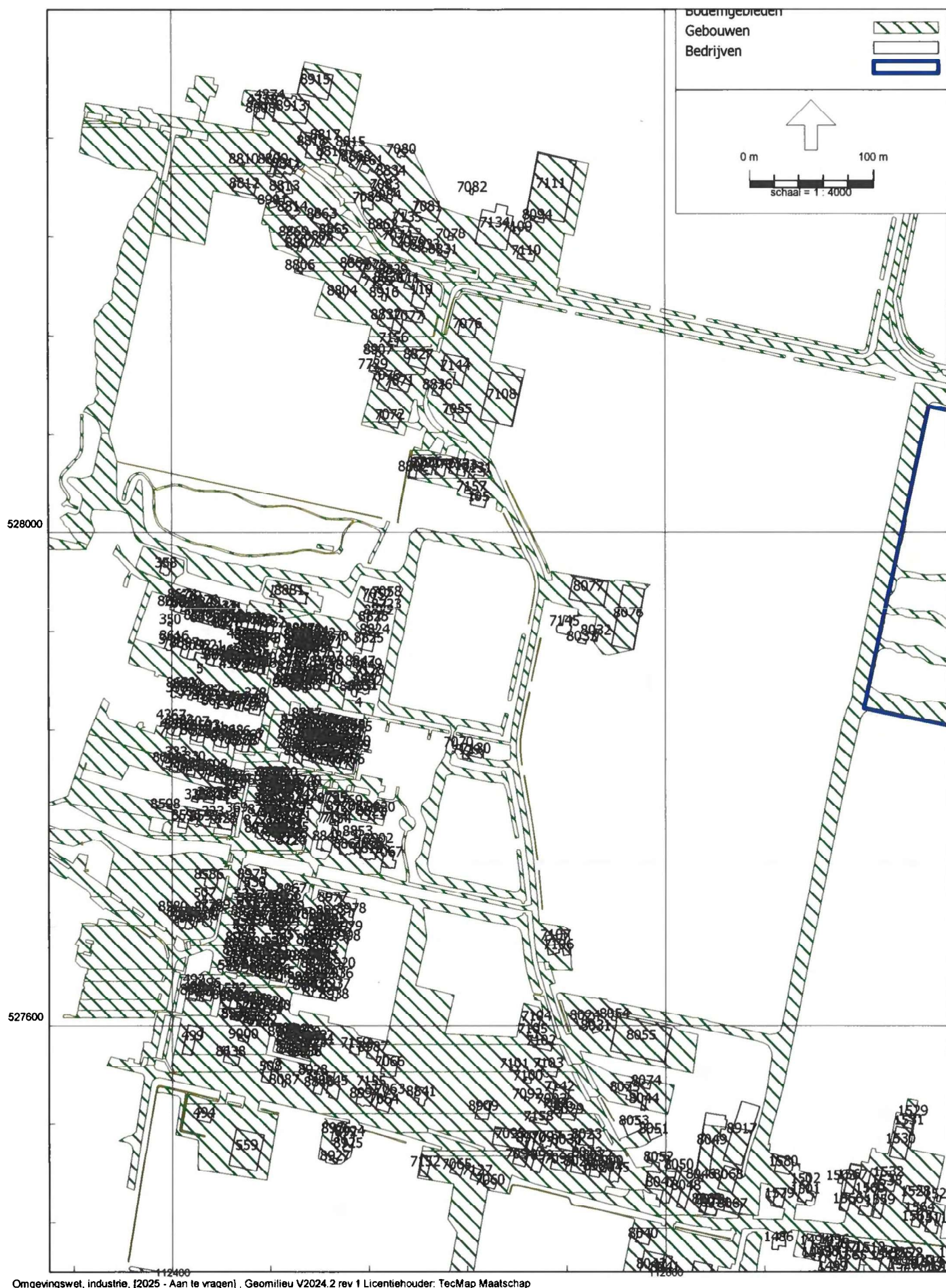
figuur 4a: Overzicht rekenmodel met positie objecten, bodemvlakken en schermen
