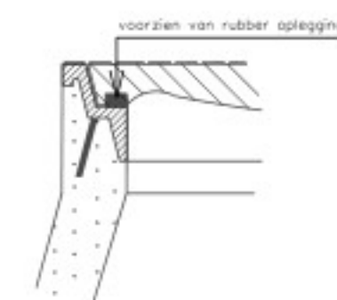
Principedetail: putrand/deksel schaal 1:10
