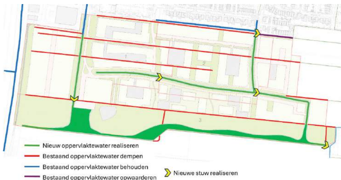
Figuur 4.2 Situering nieuw oppervlaktewater, dempen en behouden bestaand oppervlaktewater
