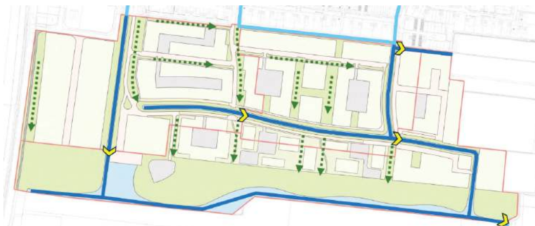
Figuur 4.7 Principe uitwerking hemelwaterstructuur (groene stippellijnen = wadi's/groene goten; blauw = oppervlaktewater)
