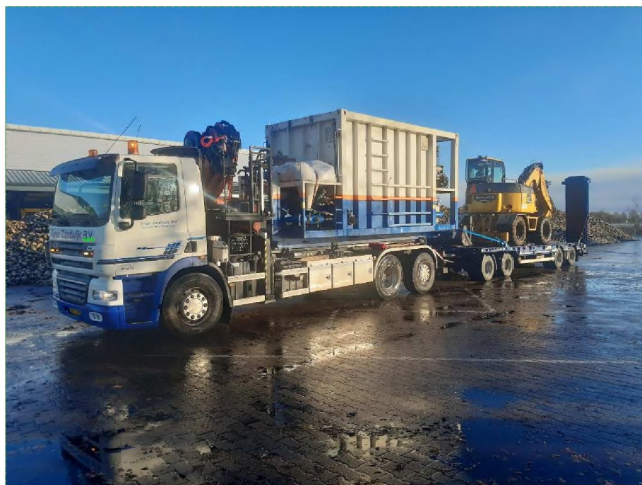
Voorbeeld van bentonietmixer en mobiele kraan.
