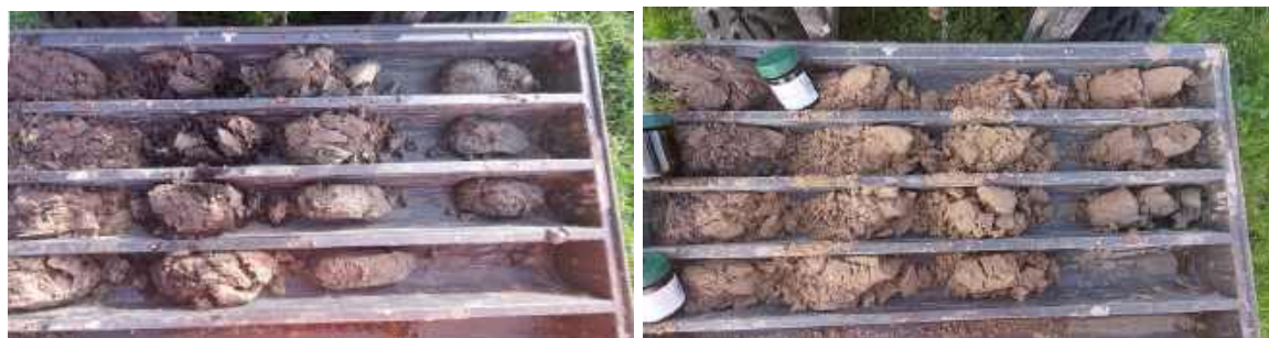
Figuur 41. Boorprofielen van de locaties 123 (links) en 500 (rechts). Foto's: Jan Vermeer.
