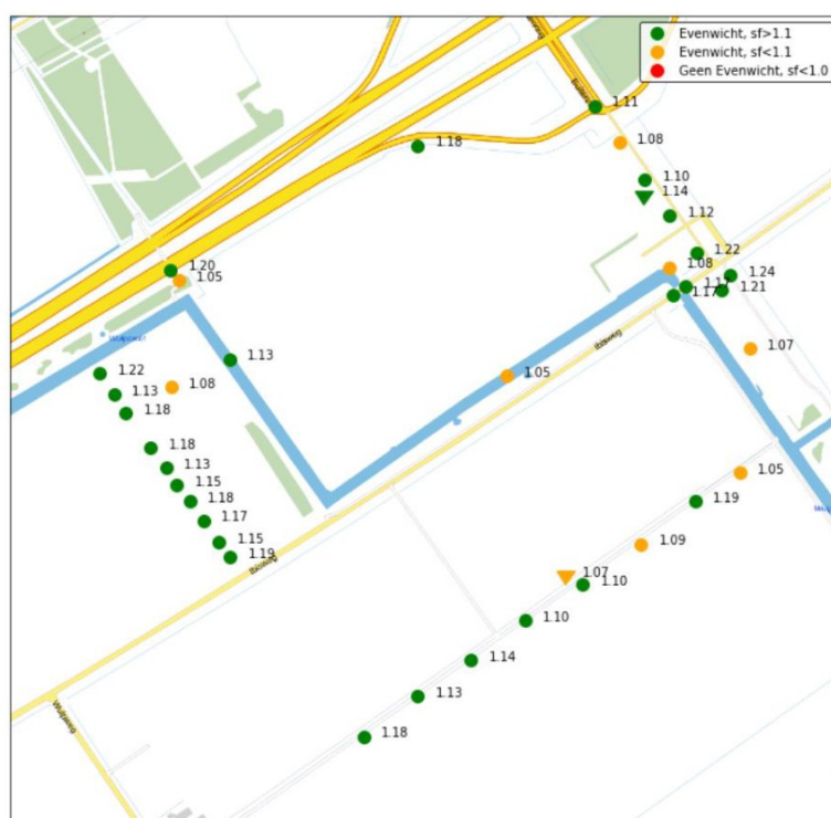
Figuur 2 Evenwicht veiligheidsfactor bij een waterpeil van N.A.P. -5,9 m (toekomstige situatie)
