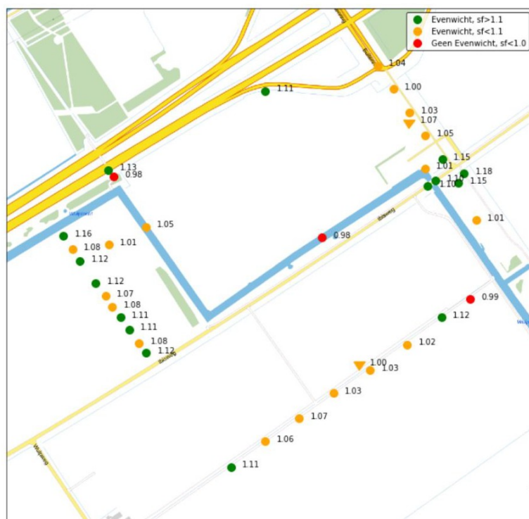
Figuur 3 Evenwicht veiligheidsfactor bij een waterpeil van N.A.P. -6,2 m (uitvoeringsfase)
