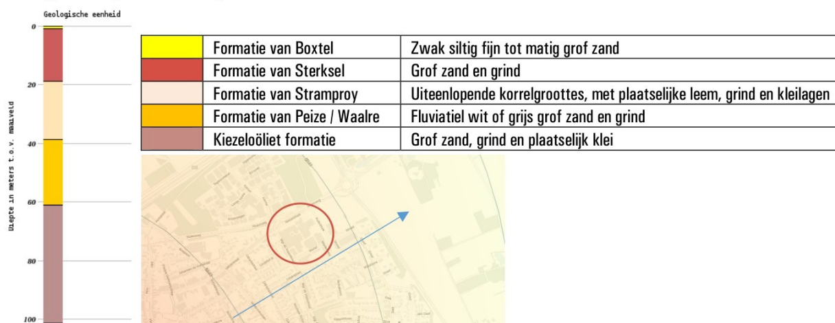
Figuur A: opbouw ondergrond.
