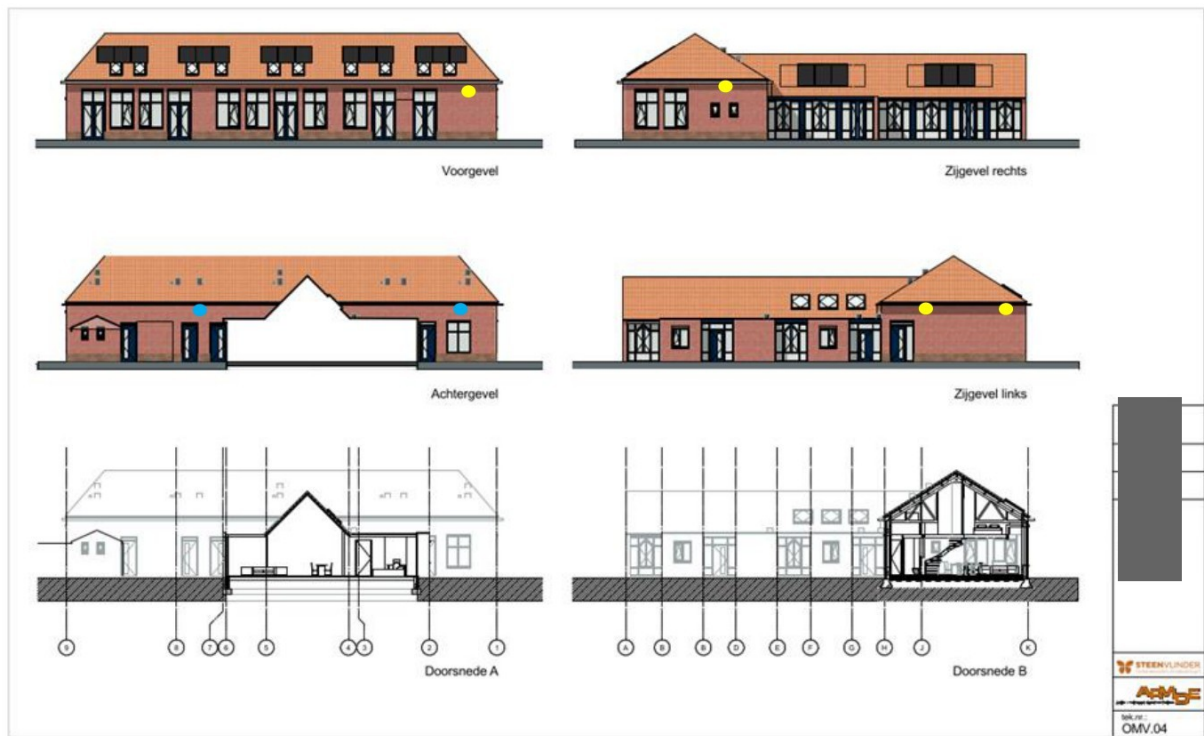
Figuur 7.5 Voorgestelde locaties voor nieuwe invliegopeningen (gele stippen) en reeds bestaande invliegopeningen naar de spouwmuur (blauwe stippen) in de toekomstige situatie.
