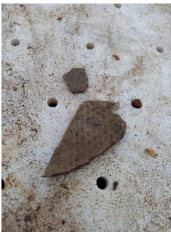
Foto 20: asbestverdacht materiaal proefgat 116
