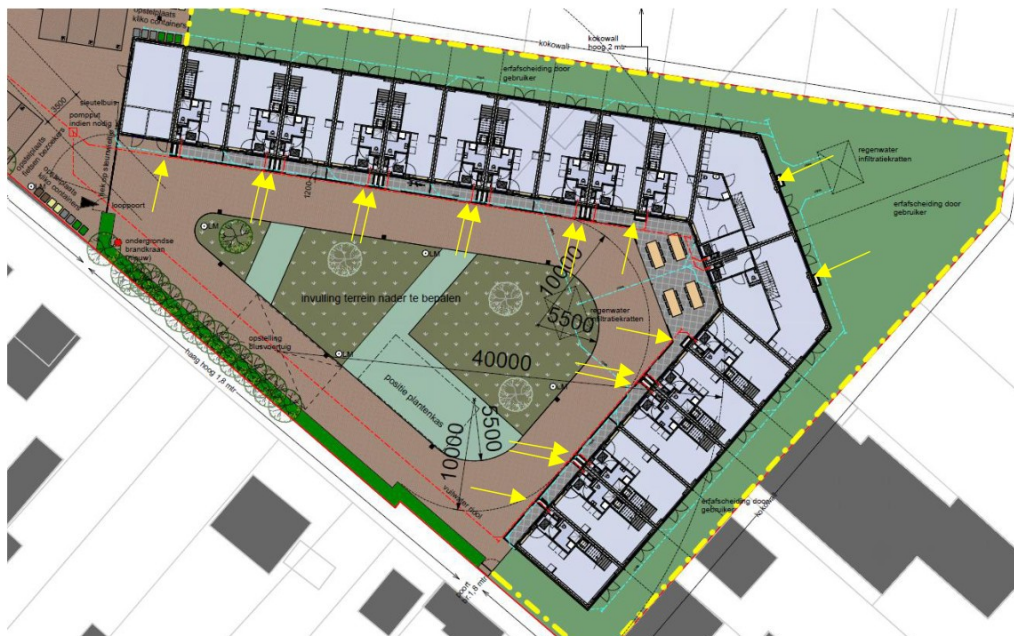
Figuur 4 Locatie warmtepompen
