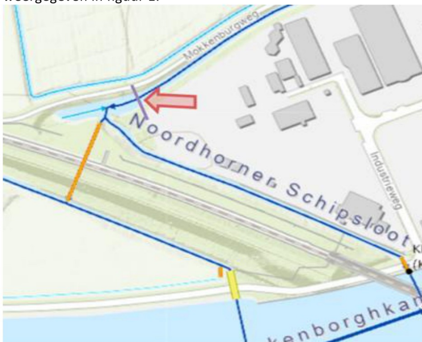
Figuur 1: De paarse lijn geeft globaal de positie van de leiding en afdamming alsook de afvoerroute van het water.
