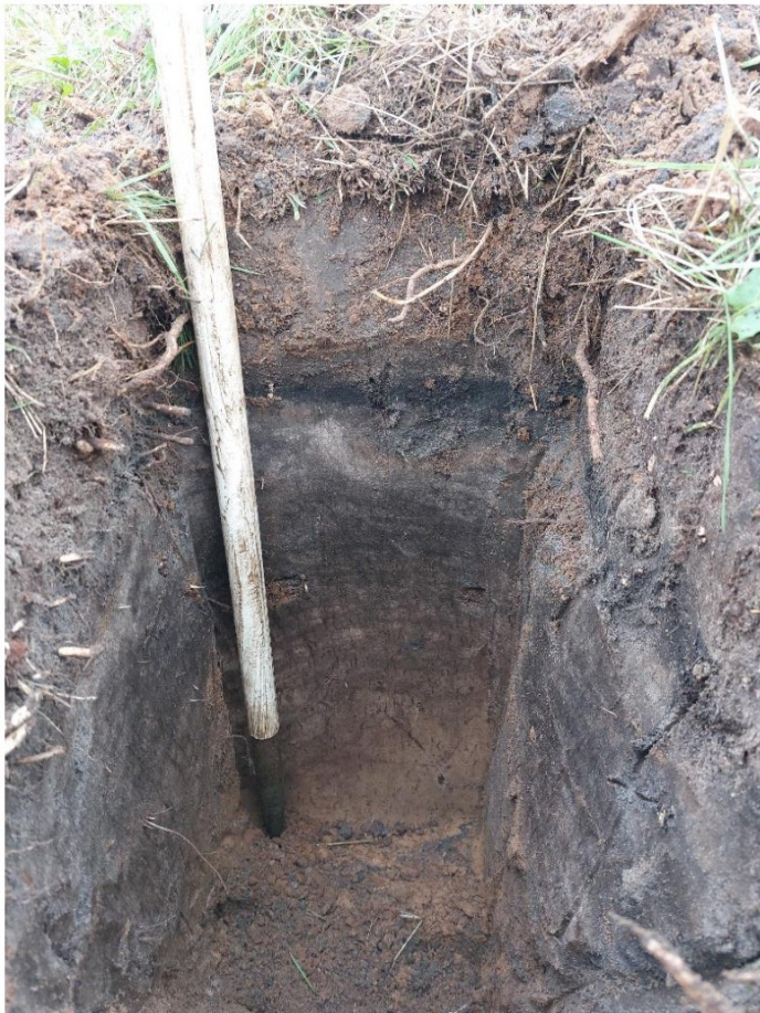
Afbeelding 2: Bodemopbouw in profielputje ter hoogte van boring 64.
