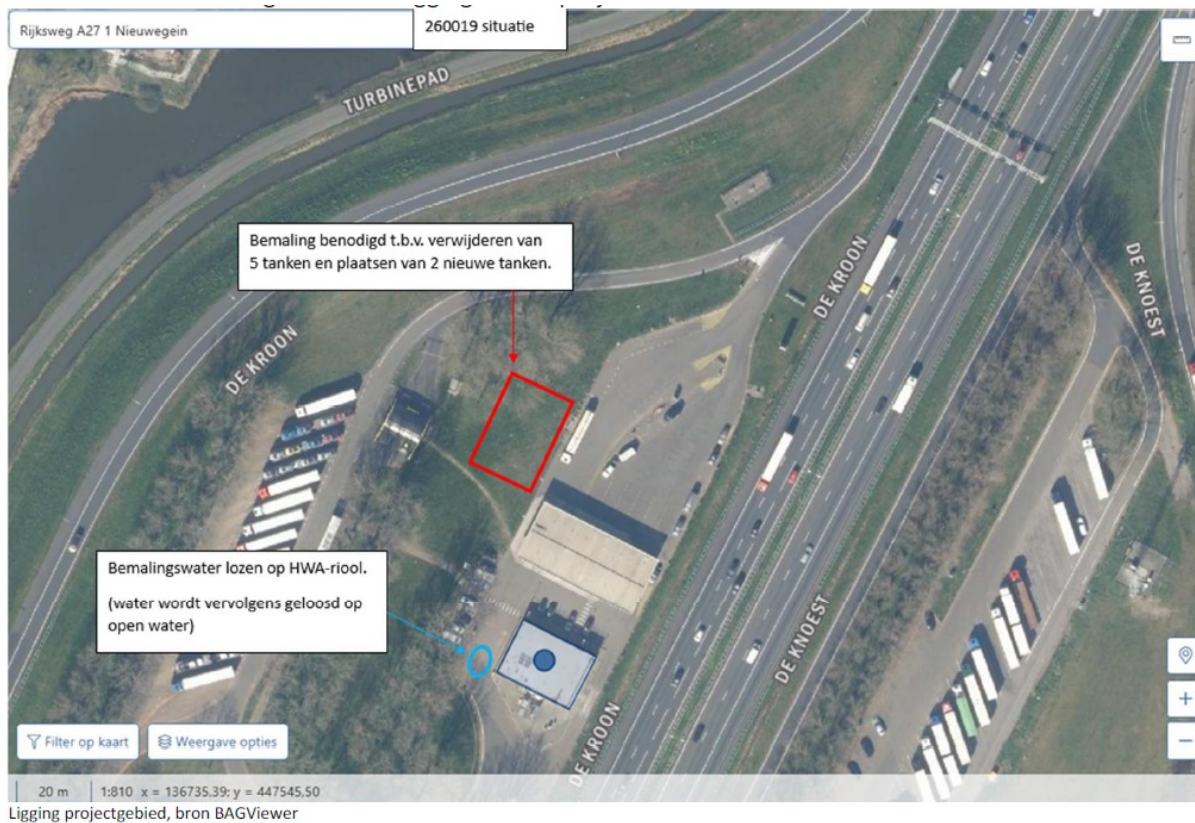
Figuur 3. Ligging ondergrondse tanks, en lozingspunt, het HWA-riool staat direct in verbinding met het oppervlakte ten noordwesten van de locatie.
