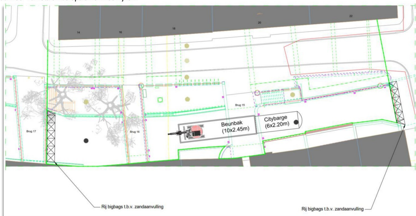
Afbeelding 3: aanvulling zand + plaatsen koppelpontons
