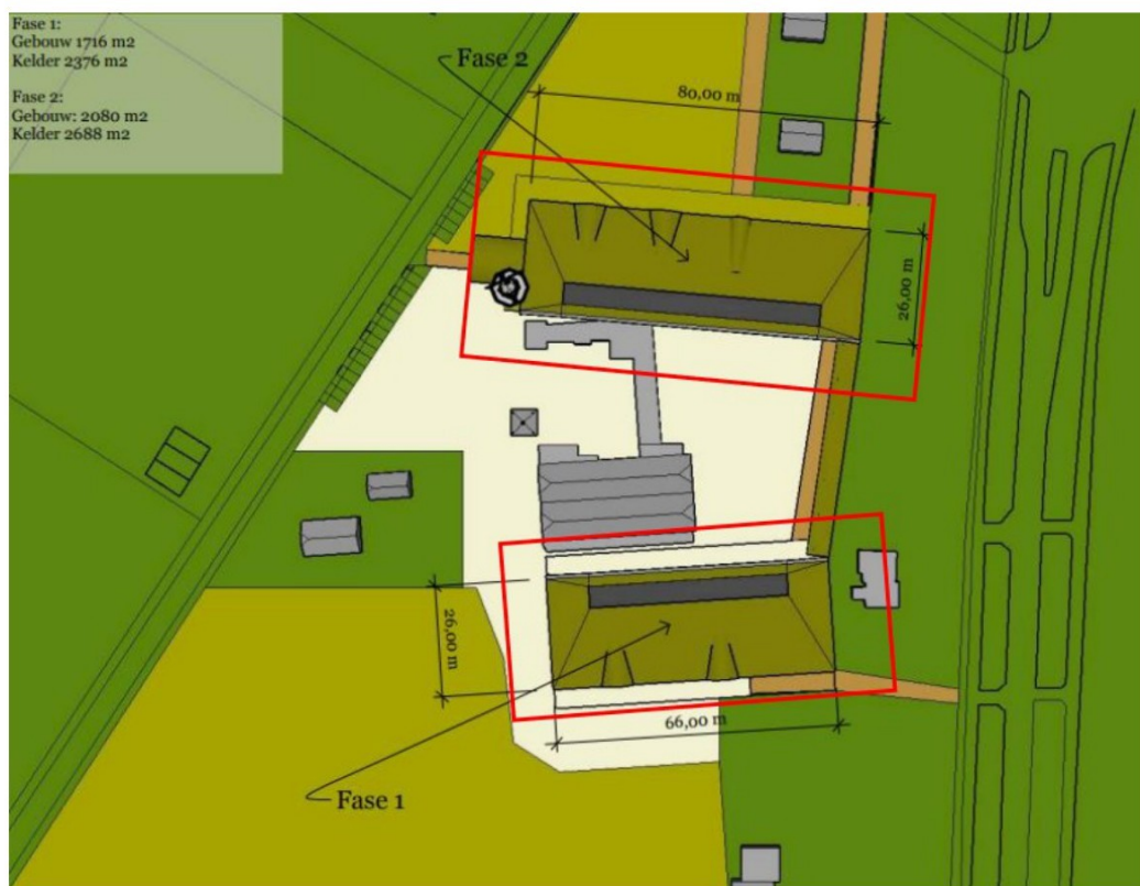
4 tekening bebouwing bovengronds, inclusief taluds en afmetingen
