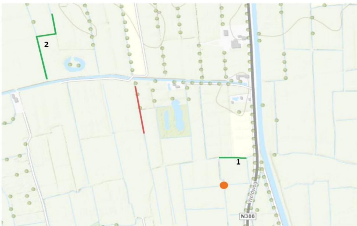
Figuur 1: Locatie van activiteiten. De rode lijn geeft de gedempte watergang weer. De groene lijn geeft de te verbreden watergangen weer. De oranje stip geeft de locatie van de aan te leggen dam met duiker weer.
