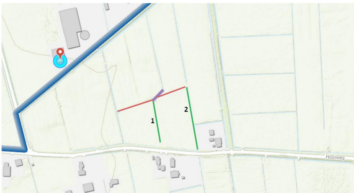
Figuur 1: Locatie van activiteiten. De rode lijn geeft de te dempen watergang weer. De groene lijnen geven de te verbreden watergangen weer. De paarse lijn geeft de locatie weer van de aan te leggen duiker.
