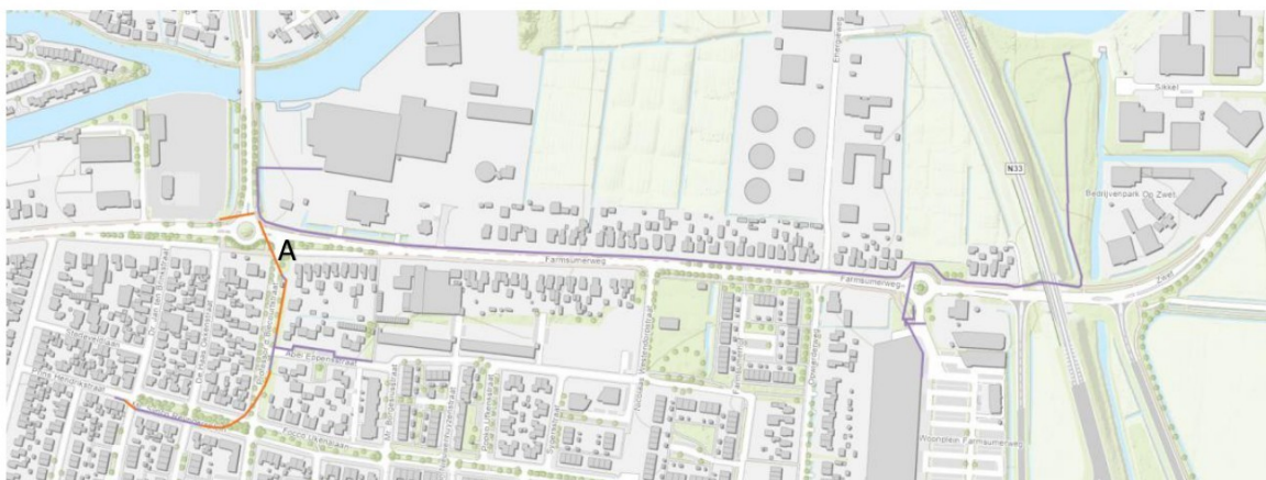
Figuur 1: De paarse belijning geeft globaal de tracés van de te leggen en te verleggen kabels. In het oranje globaal de tracés van de gestuurde boringen. Punt A geeft de gestuurde boring aan die de regionale waterkering kruist waarbij de in- en uittredingspunten zich binnen de beperkingengebieden bevinden.
