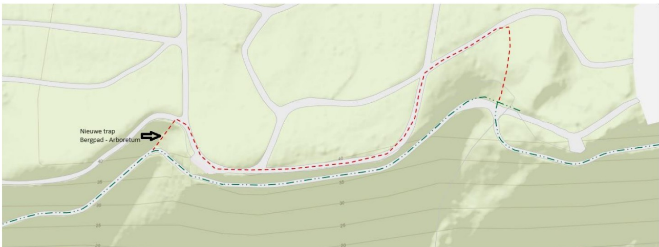
Figuur 3-6: Variant met trap ten oosten van het uitzichtpunt en verleggen wandelpad
