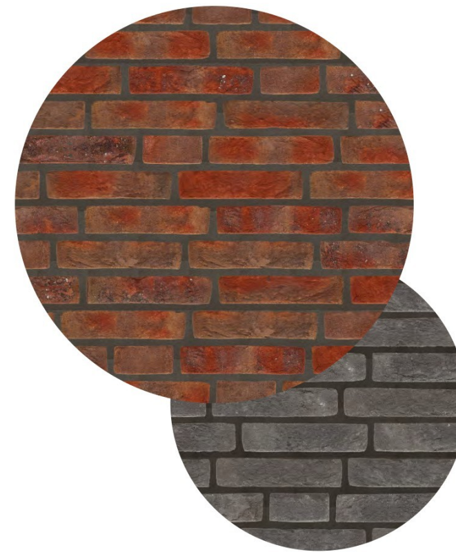
nieuwe invulling dik formaat baksteen in wildverband in twee kleuren: rood genuanceerd als basis en zwart t.p.v. de plint
