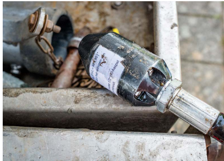
Figuur 12: 0-15° of terugspoeiende sproeikop
