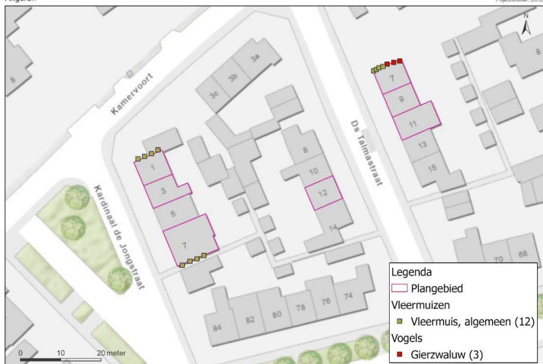
Figuur 7: Locatiebepalingen van de permanente voorzieningen die gerealiseerd zullen worden in Angeren. In het groen de permanente voorzieningen voor de vleermuis en in het rood de permanente kasten voor de gierzwaluw. Adres waar de 3 gierzwaluwvoorzieningen in de kopgevel gerealiseerd worden: Dominee Talmastraat 7.
