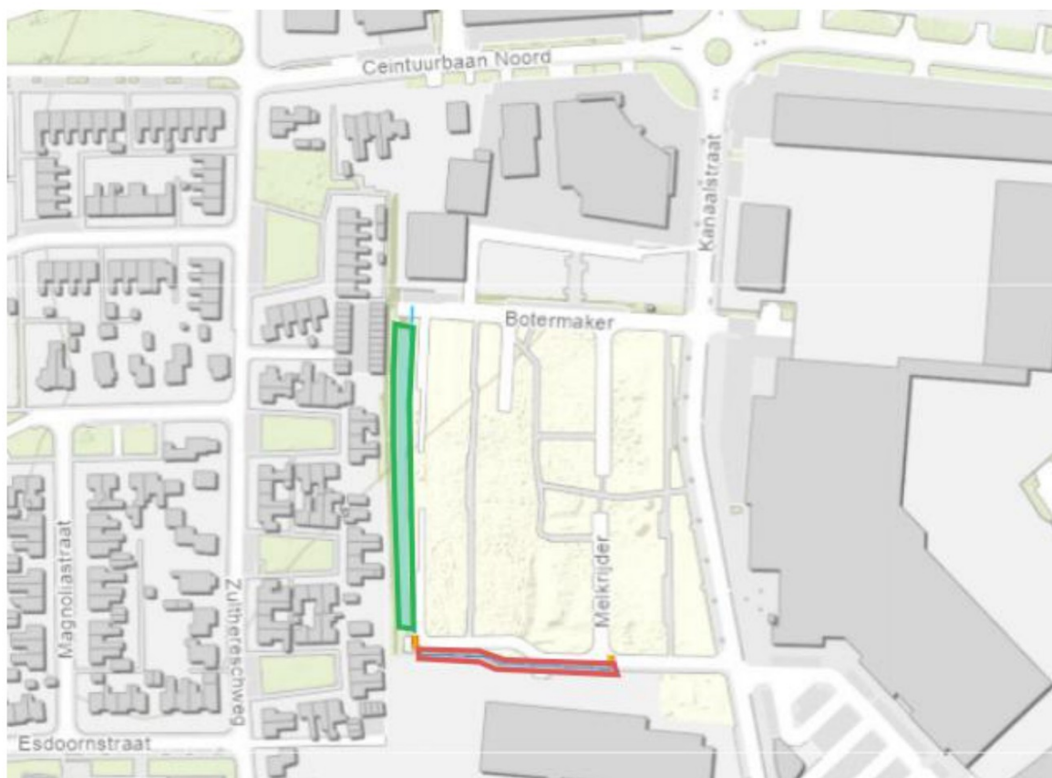
Figuur 1: Locatie van activiteiten. Het rode vlak geeft het te dempen oppervlaktewaterlichaam weer. Het groene vlak geeft het te verbreden oppervlaktewaterlichaam weer.
