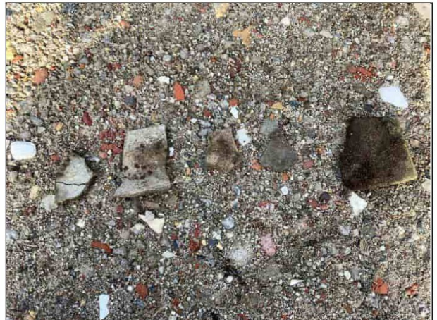
Foto 4 Enkele asbestverdachte fragmenten t.p.v. noordzijde puinverharding
