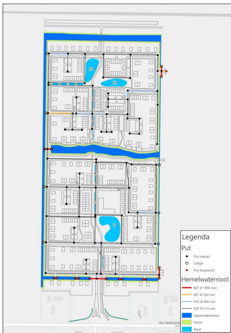
Afbeelding 3.2: Structuur hemelwaterafvoer
