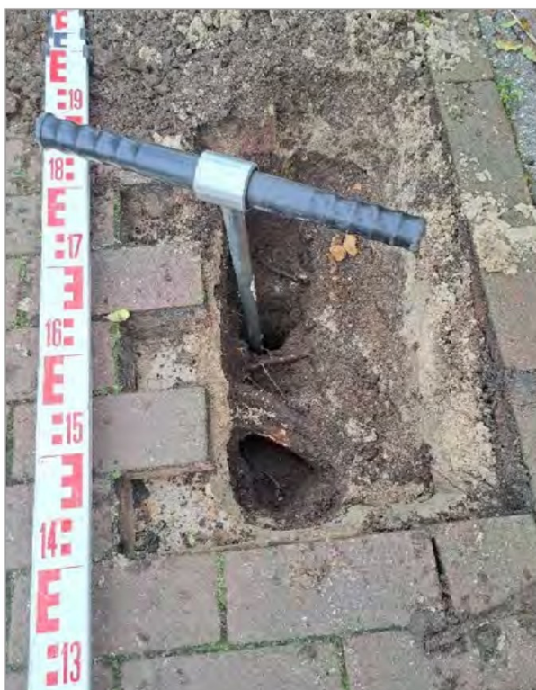
Foto 6: Beeld van kuil /boring 1. Grondwaterspiegel op 140 cm
