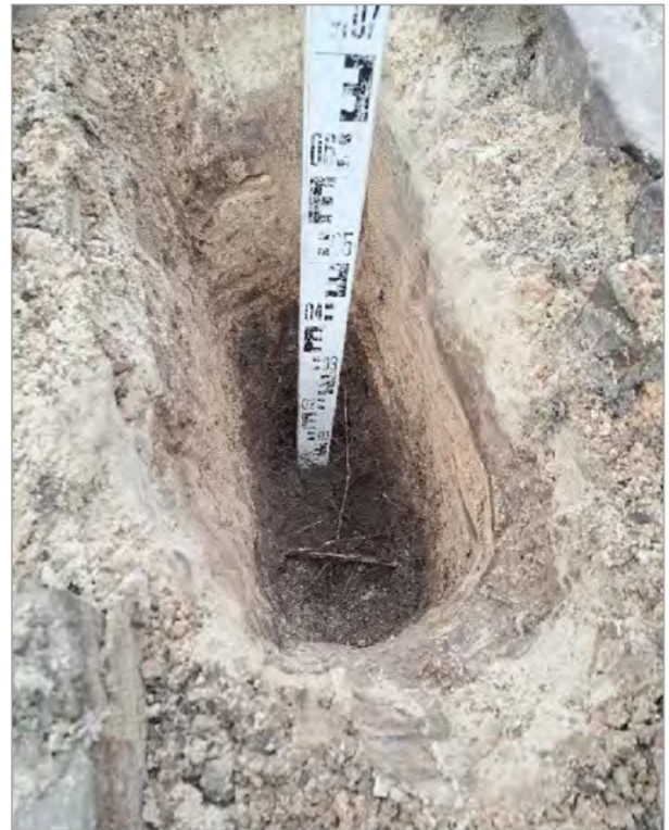
Foto 9: Kuil 3, Lichte kleur van de bodem: humusarm
