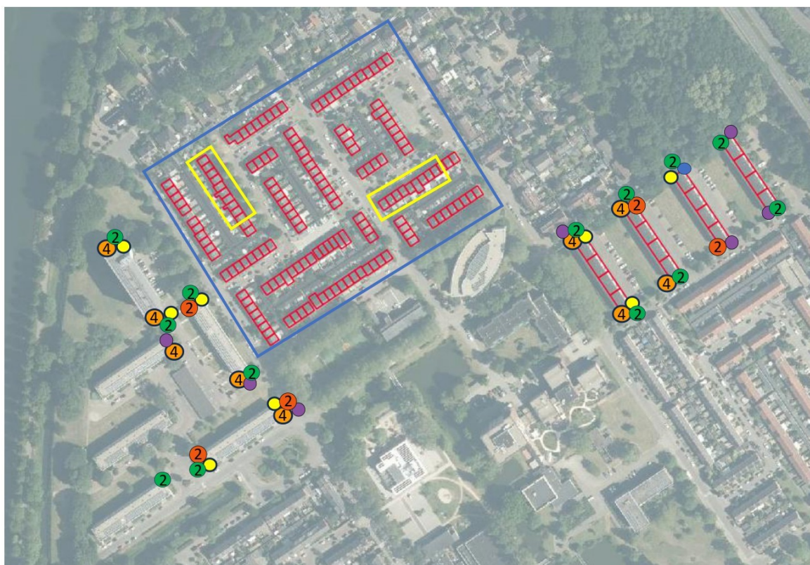
Figuur 10: Overzicht plangebied met te renoveren woningen (woningen binnen het blauwe kader) en de locaties met aan te brengen tijdelijke kasten. Geel omkaderd de twee woonblokken waar de werkzaamheden per mei '26 aanvangen.
