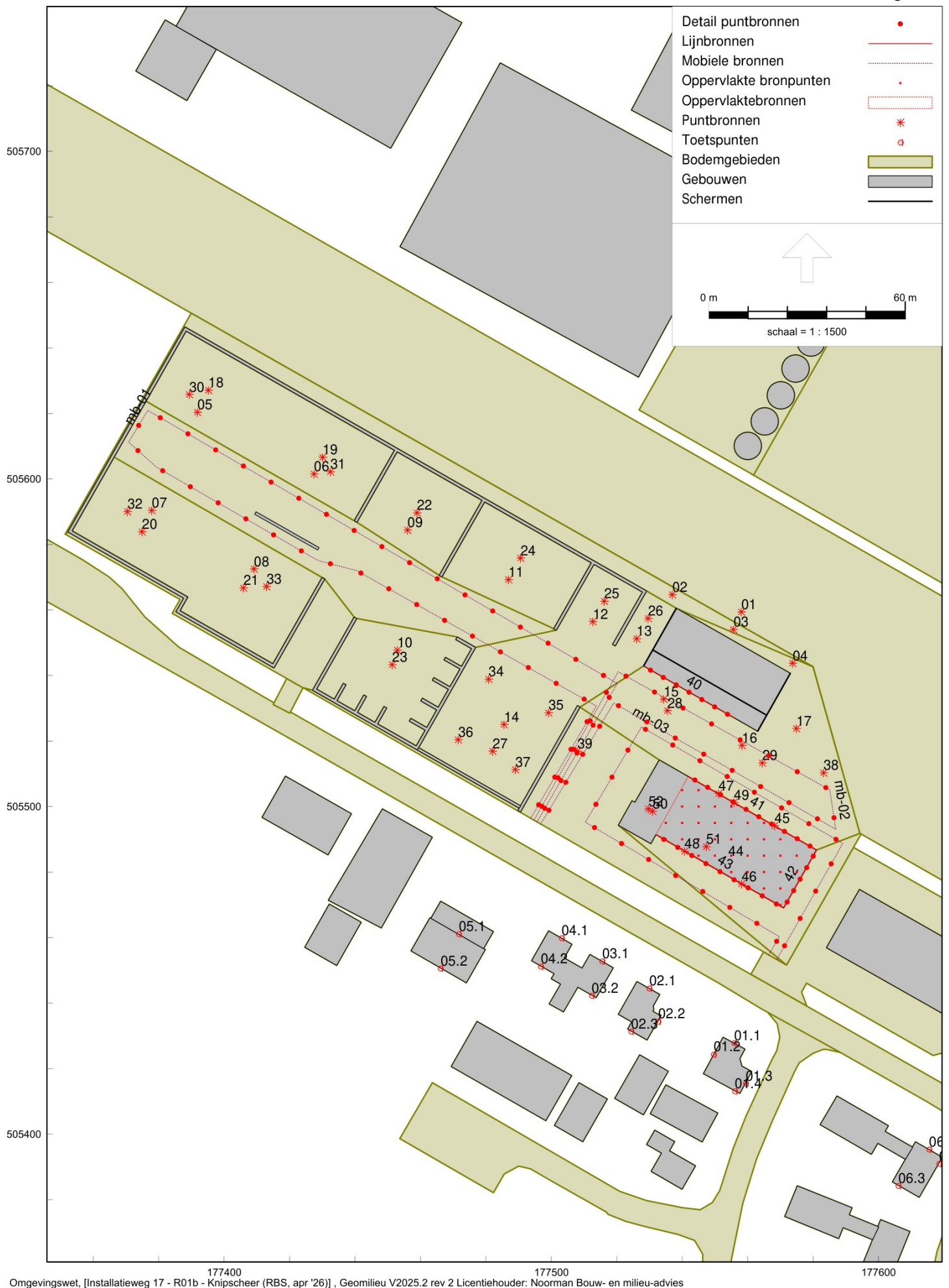
Overzicht van het akoestische rekenmodel met de ligging van de equivalente geluidbronnen (LAR,LT) - RBS
