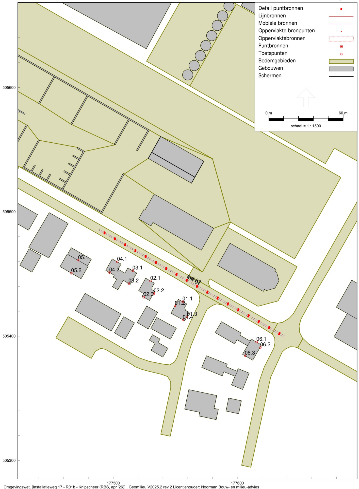
Overzicht van het akoestische rekenmodel met de ligging van de equivalente geluidbronnen (indirecte hinder)
