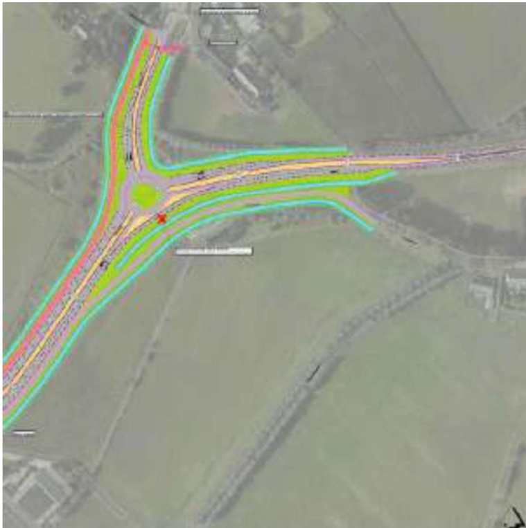
Figuur 3 Uitsnede schetsontwerp Rtonde West-Om, Variant E1 Reconstructie rotonde tot turborotonde, aansluiting Broekstraat en fietsoversteek verval
