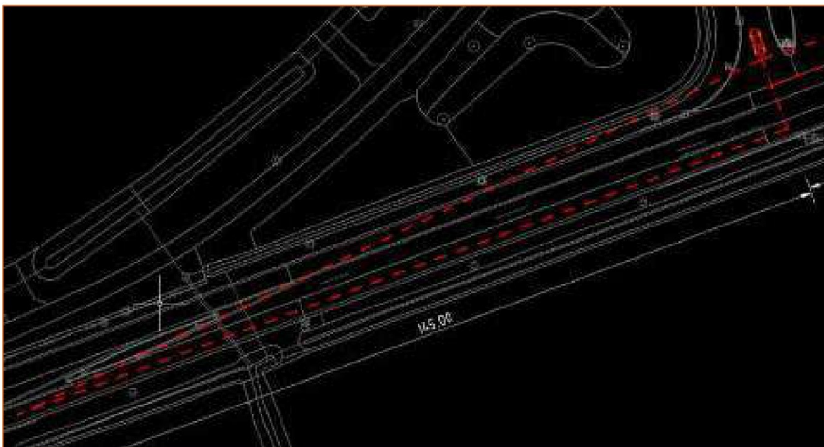
Figuur 57: uitzichtdriehoek op basis van een benodigd oprijzicht van 145 meter bij een linksafslaande beweging
