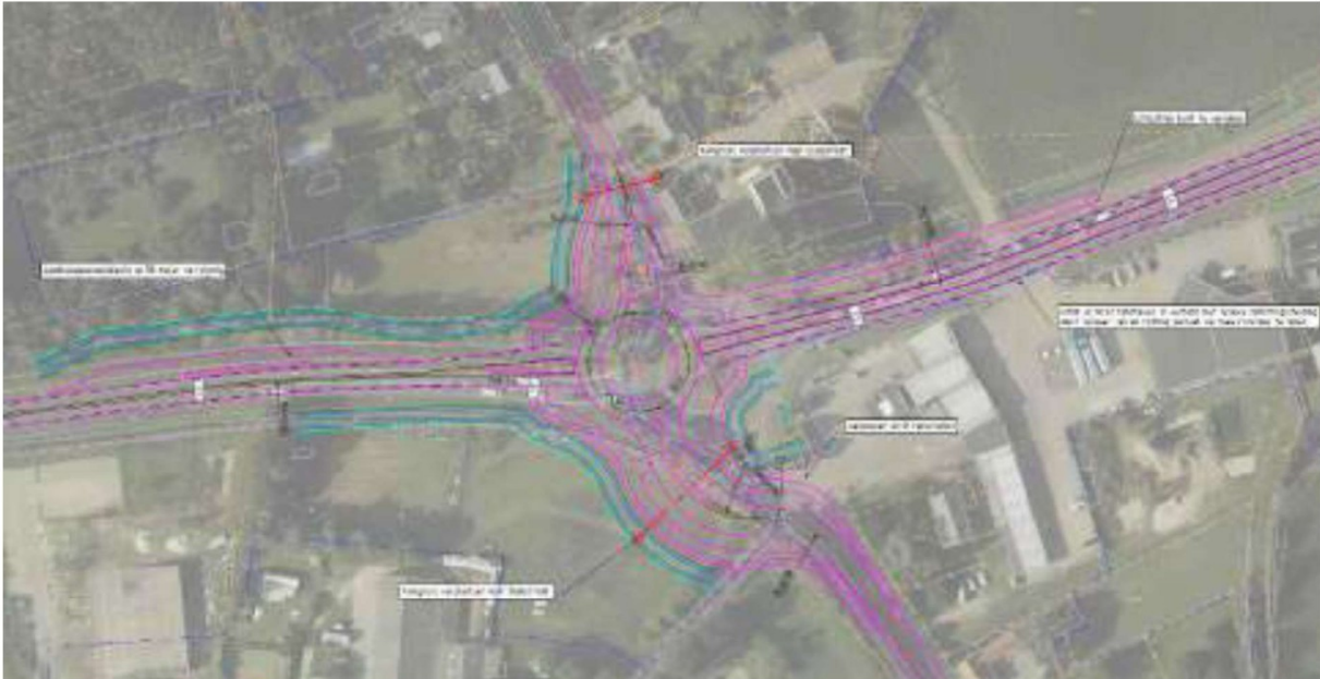
Figuur 40: enkelstrooks rotonde buiten de bebouwde kom met vrijliggende fietsvoorzieningen en aangepaste toerit tankstation
