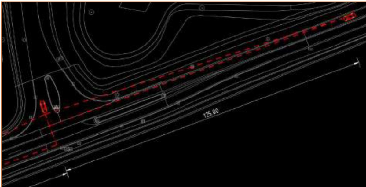
Figuur 56: uitzichtdriehoek op basis van een benodigd oprijzicht van 125 meter bij een rechtsafslaande beweging
