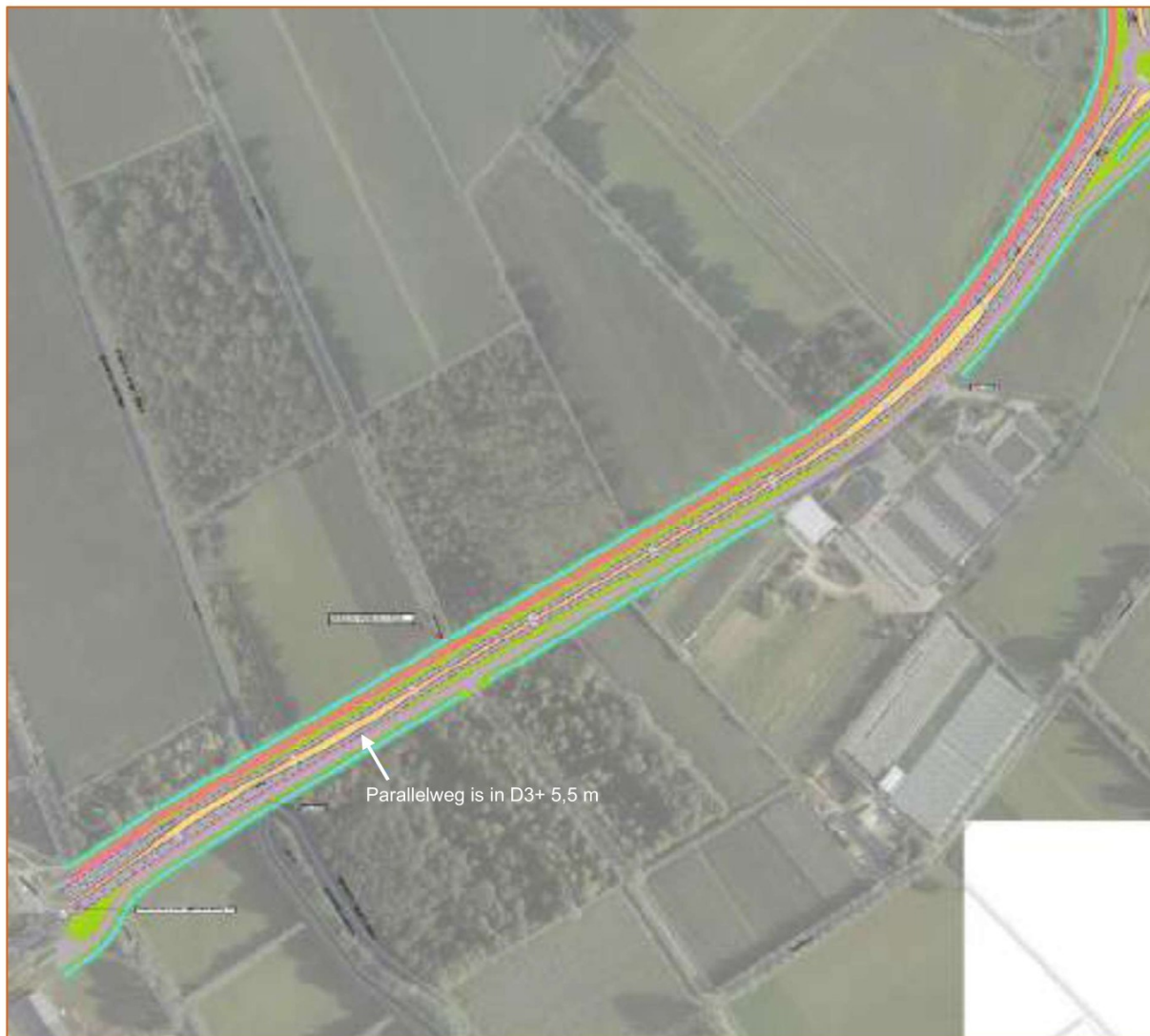
Figuur 59 Uitsnede schetsontwerp aanpassing tracé N272 (tussen N279 en West-Om), Variant D3+ met 2x1 profiel en fysieke middenberm, een snelfietsroute langs de noordzijde (4,5 m breed) én parallelweg langs de zuidzijde (5,5 m breed).
