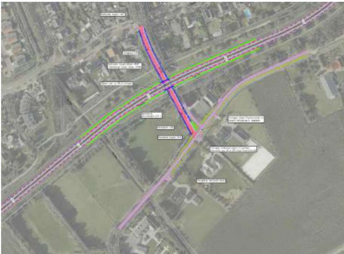
Figuur 3-23 Schetsontwerp N272 Variant H2+ Omvormen koude oversteek Eeuwsel tot ongelijkvloerse kruising (rechte fietstunnel, max. verhoging N272 0,4 m en aanpassen Paashoefsedijk)
