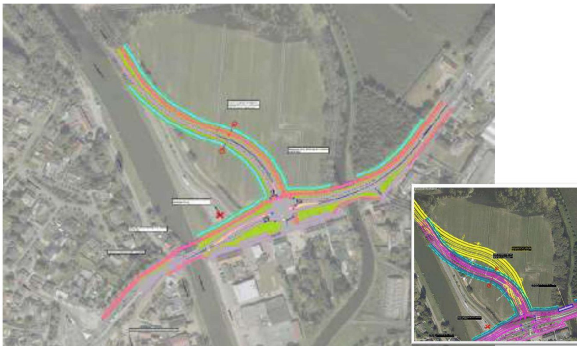
Figuur 3-5 Uitsnede schetsontwerp variant B2 Kruispunt Bosscheweg verschuiven in NO-richting (incl. snelfietsroute noordzijde N615 met fietsbrug (De uitsnede laat het verschil zien tussen B2 (geel) en B2A (roze))
