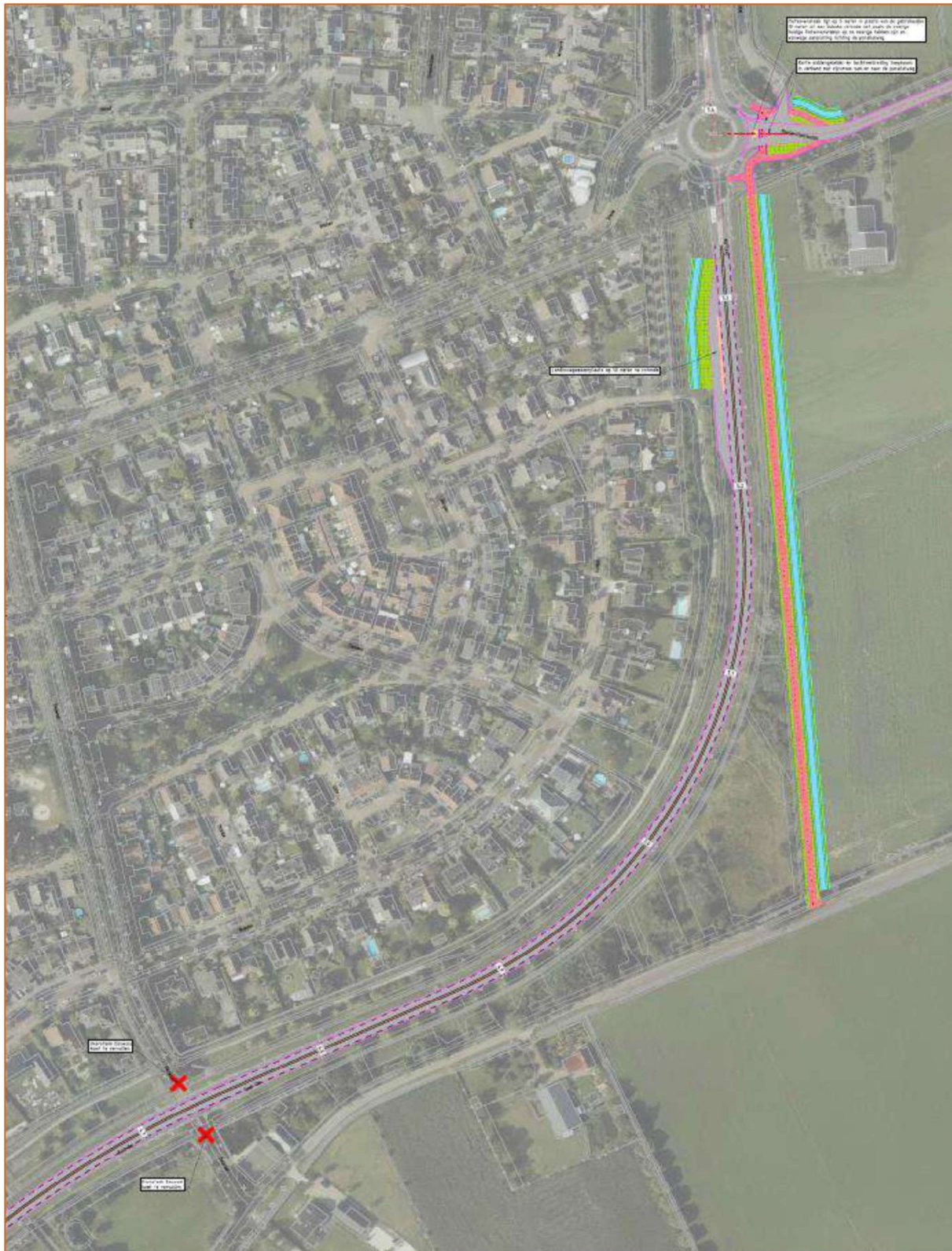
Figuur 3-21 Schetsontwerp N272 Variant H1 koude oversteek Eeuwsel opheffen en nieuw fietstracé realiseren
