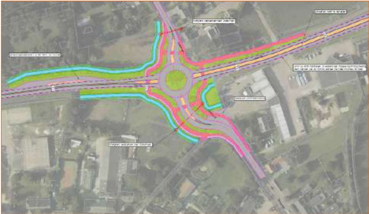
Figuur 3-19 Uitsnede schetsontwerp Ronde Oudestraat, Variant F2 met verder doorgetrokken fysieke rijbaanscheiding waardoor de toegang naar het tankstation wijzigt
