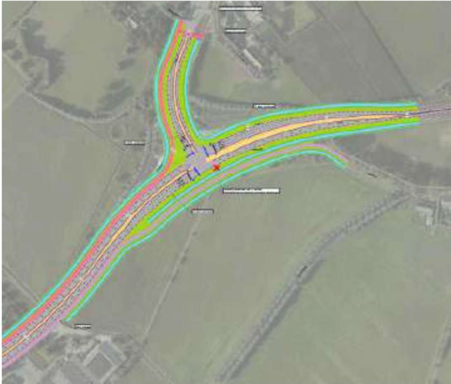
Figuur 3-14 Uitsnede schetsontwerp Ronde West-Om, Variant E2 Reconstructie rotonde tot een kruispunt met verkeerslichten, aansluiting Broekstraat en fietsoversteek vervalt
