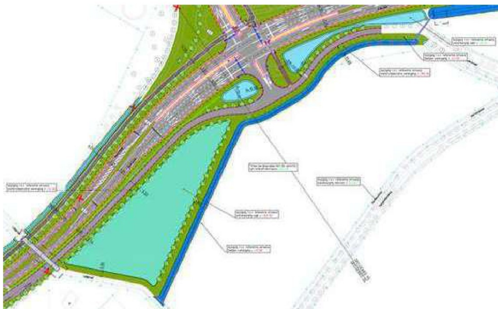
Figuur B2.9 Verandering bergingscapaciteit ten opzichte van het RO door verleggen van de Mortelseloop
