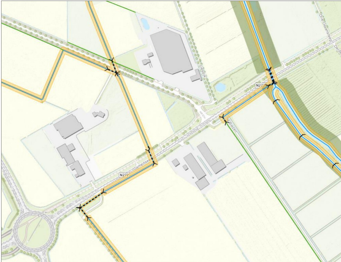
Fig. 9. Uitsnede van de leggerkaart met A- (blauwe lijn) en B-(groene lijn) watergangen en bijbehorende onderhoudsstroken (oranje) (bron: Legger kaart waterschap Aa en Maas)
