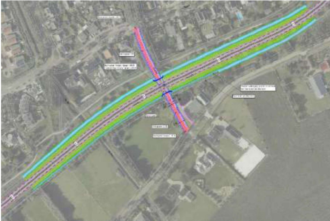
Figuur 3-22 Schetsontwerp N272 Variant H2 Omvormen koude oversteek Eeuwseel tot ongelijkvloerse kruising (rechte fietstunnel, max. verhoging N272 1,0 m)
