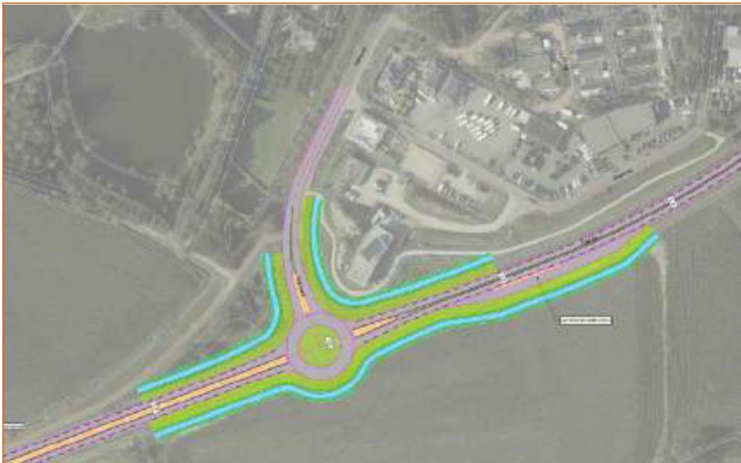
Figuur 3-20 Uitsnede schetsontwerp variant F3 aansluiting N272- Heijtsveld met rotonde (geen varianten)
