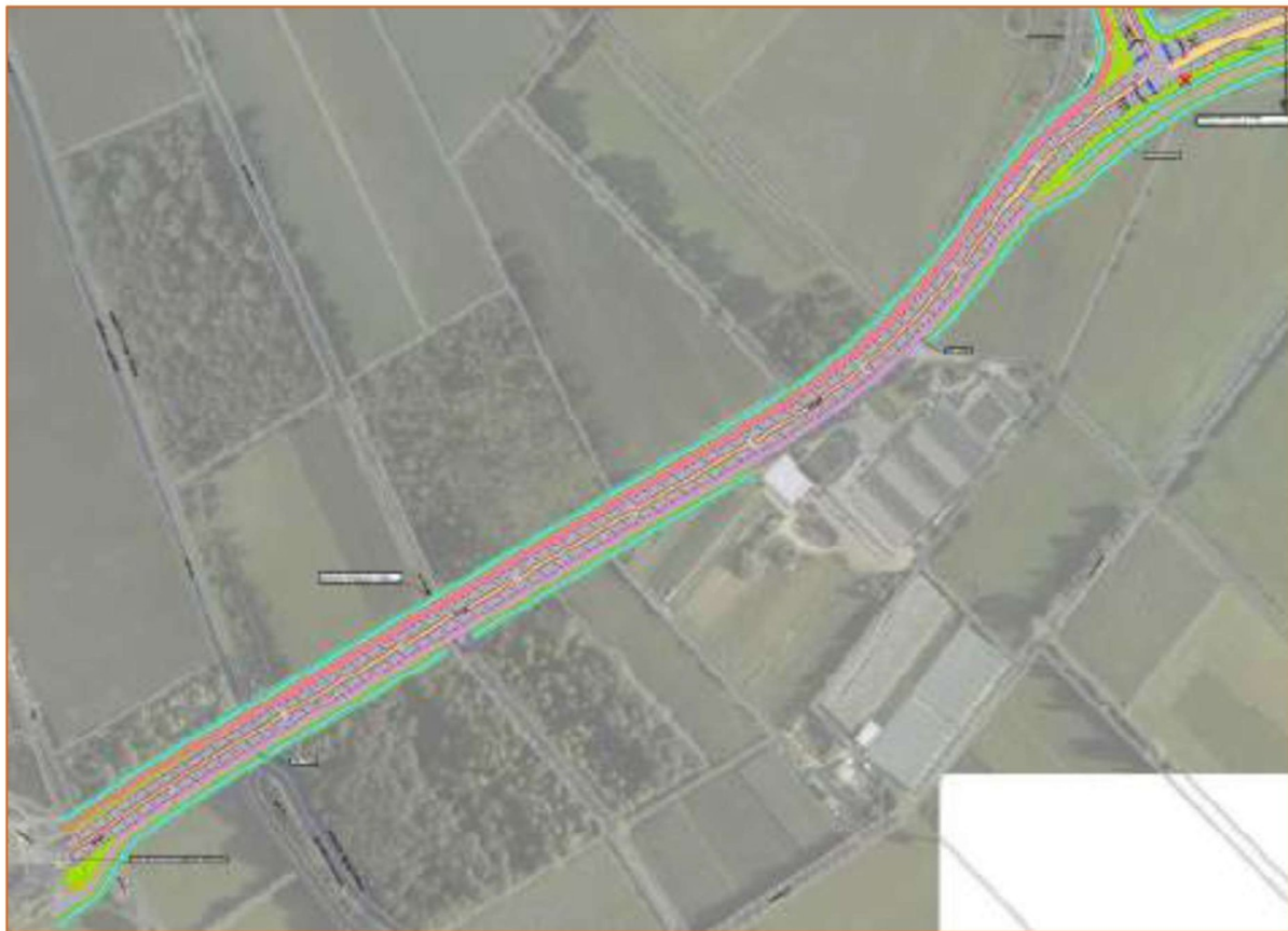
Figuur 3-10 Schetsontwerp aanpassing tracé N272 (tussen N279 en West-Om), Variant D1 met 2x2 wegprofiel met fysieke middenberm, een snelfietsroute langs noordzijde én parallelweg langs de zuidzijde.
