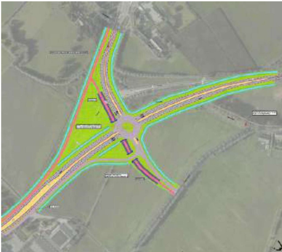
Figuur 3-15 Uitsnede schetsontwerp Ronde West-Om, Variant E3 Reconstructie rotonde tot 4-taks turborotonde inclusief aansluiting Broekstraat, fietsoversteek wordt fietstunnel.
