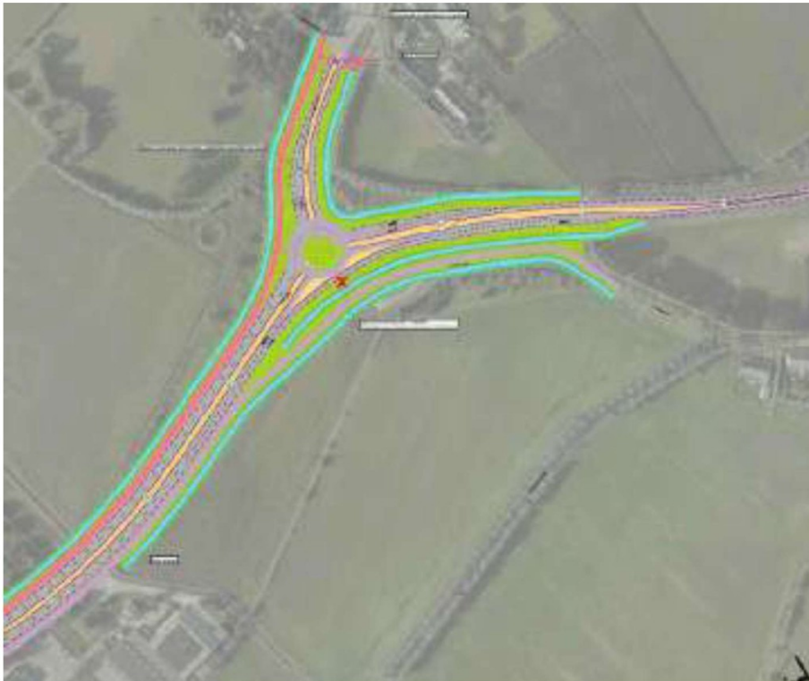
Figuur 3-13 Uitsnede schetsontwerp Rotonde West-Om, Variant E1 Reconstructie rotonde tot turborotonde, aansluiting Broekstraat en fietsoversteek vervalt
