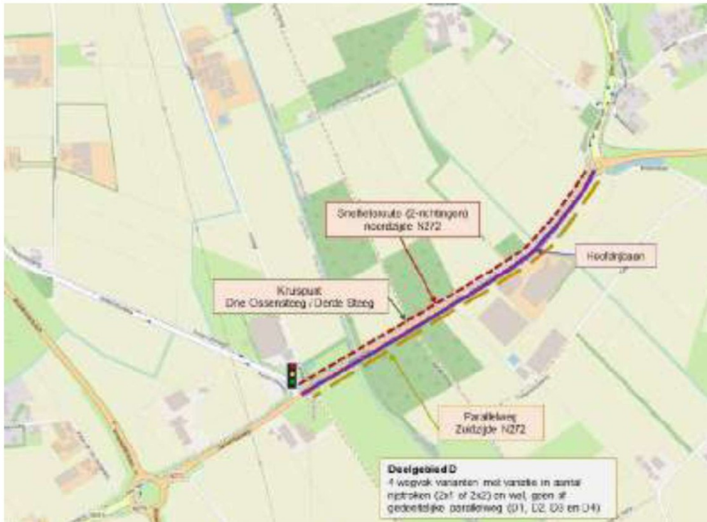
Figuur 3-9 Schematische weergave varianten N272 (tussen N279 en West-Om)
