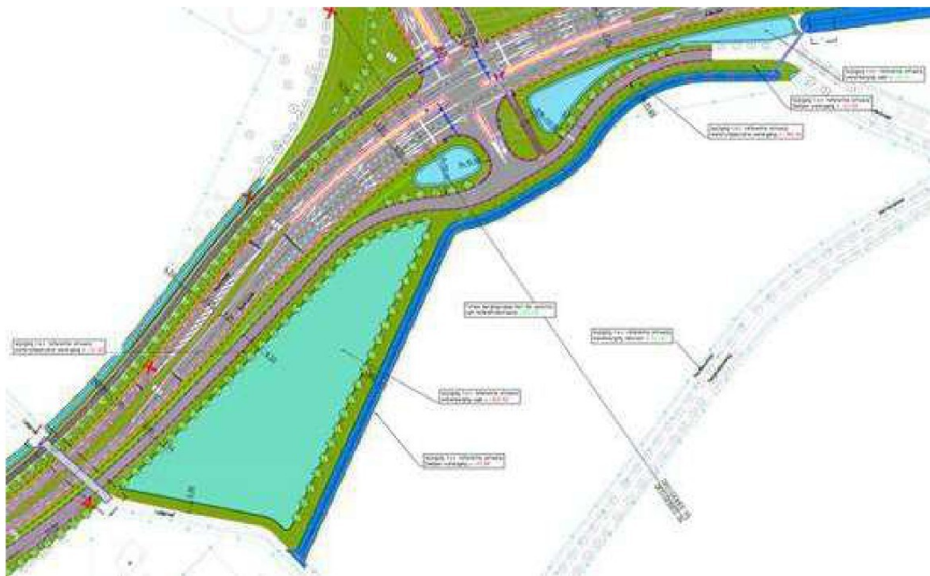
Figuur B2.9 Verandering bergingscapaciteit ten opzichte van het RO door verleggen van de Mortselloop
