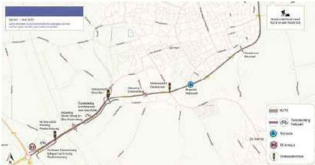
Figuur 3.2 Schematische weergave wegwerkzaamheden N272 (Bron: N272 bij Gemert - Brabant )
