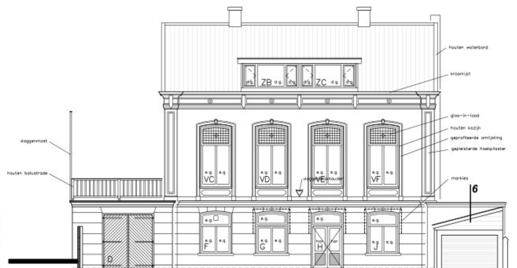
-RECHTER ZIJGEVEL- BESTAANDE TOESTAND
