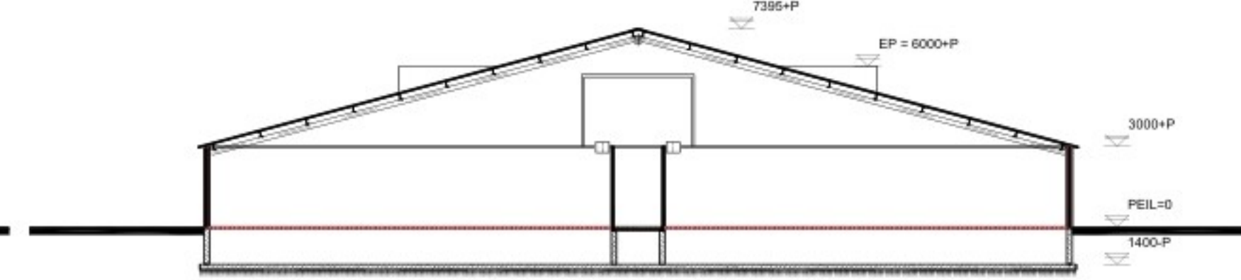
DOORSNEDE D-D GEBOUWNR D wanden pefab betonelementen vloeren betonvloer, betonroosters dak sandwich panelen mestopslag 1280 m 3
