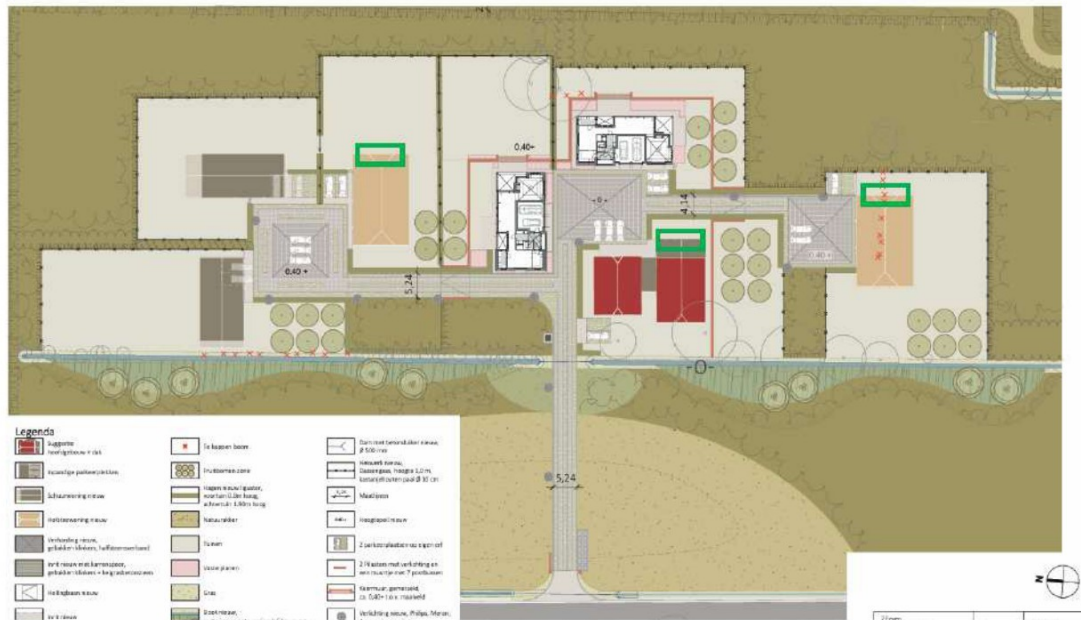
Figuur 4a: Ontwerp van de toekomstige woonerven met de locatie van de permanente huismuskasten aan de oostgevels van de woningen (groen omlijnd). Op de nieuwbouwwoningen (oranje daken) worden op elke kopgevel 5 inbouwnestkasten gerealiseerd. Aan de aanbouw van de te renoveren boerderij (rood dak) worden 6 inbouwnestkasten gerealiseerd
