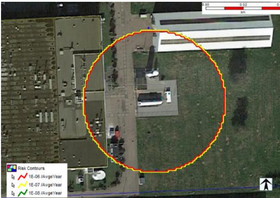
Figuur 6.5: contour PR 10^{-6} voor waterstofopslag (QRA d.d. 4 december 2024).
