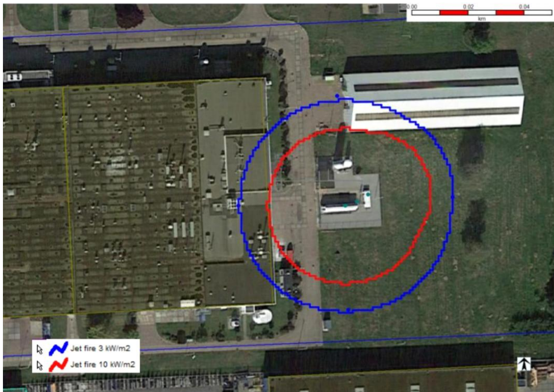
Figuur 3. Contouren 3 en 10 kW/m 2 H 2 -installatie CoorsTek
