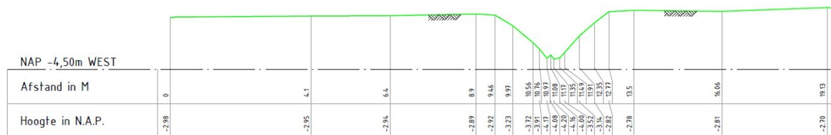
Figuur 7 – dwarsprofiel kavelstoot tussen kavel 8 en 9 (dwarsprofiel 4)
